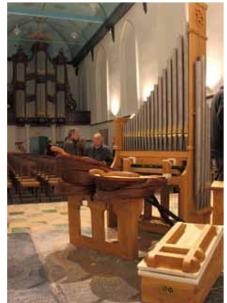
Op deze foto zijn de zakbalgen te zien waarmee het positief handmatig van wind kan worden voorzien.
